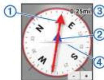
コースポインター①は目的地を導くコースラインとの関係を示しています。コース脱線インジケータ(CDI)②はコースからの脱線傾向(右/左)を示しています。数値③はコース脱線インジケータ上のドット④間の距離を示しており、コースからどの位離れているかが分かります。
