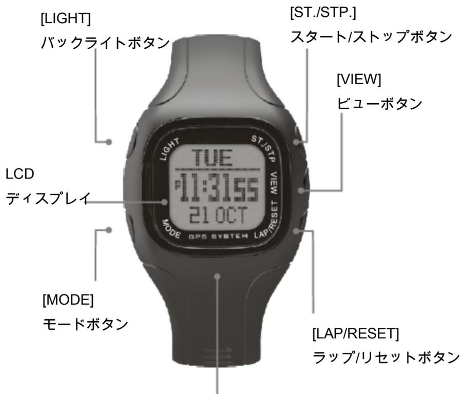
GPS アンテナ内蔵位置：最適な状態で GPS を受信するためには、上空が開けたところで使用して下さい。室内では GPS 衛星を捕捉できません。
